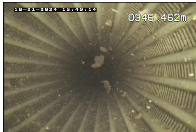
FOTO 20 – Visada de fundo – filtro Ø 4".
