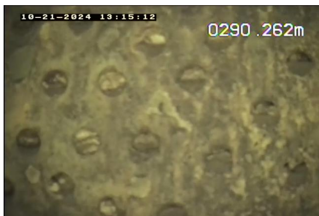
FOTO 18 – Visada lateral – filtro jaquetado.
