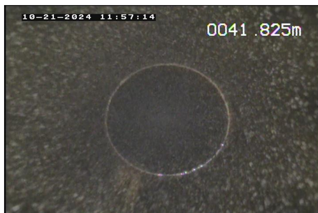
FOTO 03 - Visada de fundo – tubo de aço oxidado.
