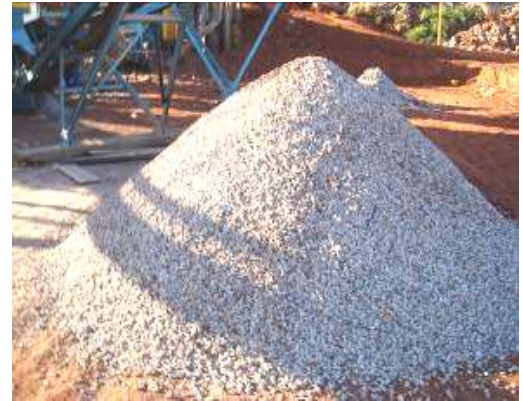
Foto 8.1.3.3-2 Agregado reciclado produzido na Usina de RCC da Morada Ambiental
