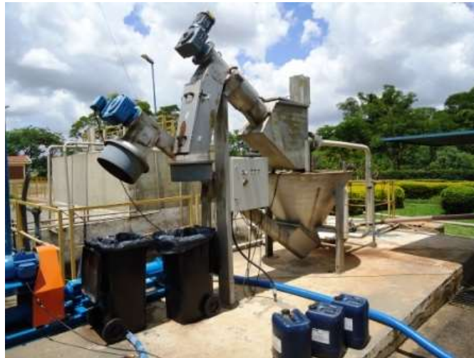
Foto 6.1.2-1 Equipamento Mecanizado denominado Rotamat
