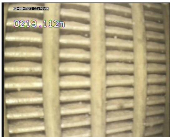
Foto 11: Tubo Espiralado sem furos e sem colmatção.
