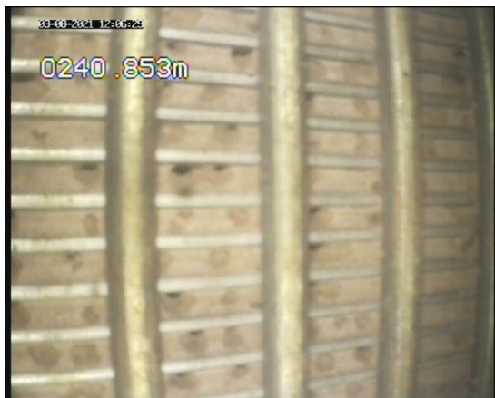
Foto 13: Tubo Espiralado com furos.
