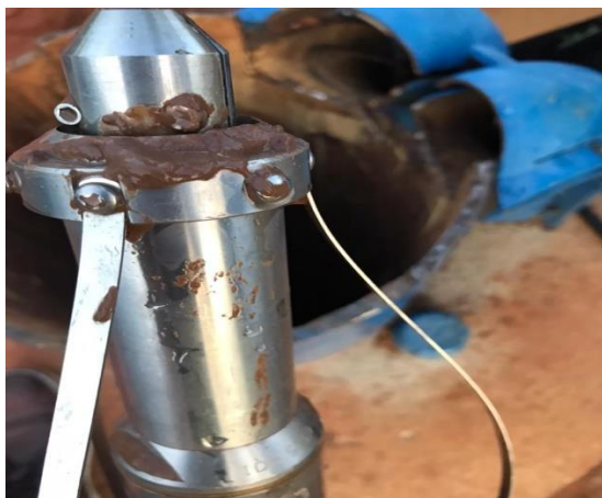
Foto 25: Camera retirada com detritos Sedimentados
