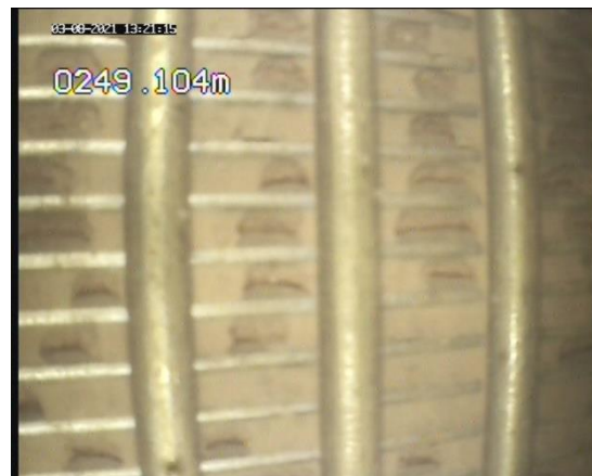
Foto 14: Tubo Espiralado com furos.
