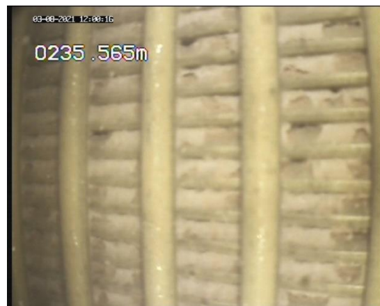
Foto 12: Tubo Espiralado com furos.
