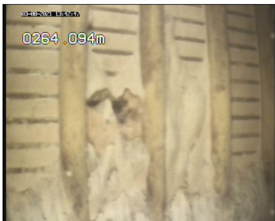
Foto 17: Tubo Espiralado Colmatado e com furos.
